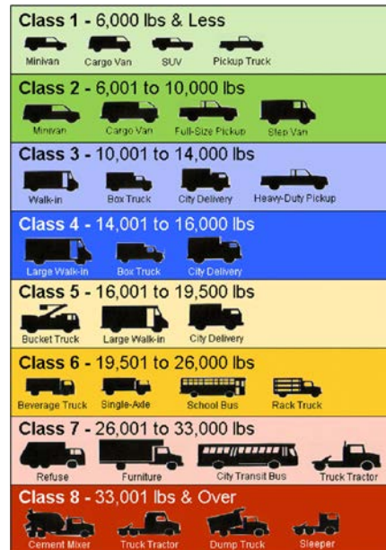
Figure 1. Catégories de poids des véhicules telles que définies par la Federal Highway Administration, US Department of Transportation (USDOT). Source : Département de l'énergie des États-Unis, Office of Energy Efficiency and Renewable Energy.
